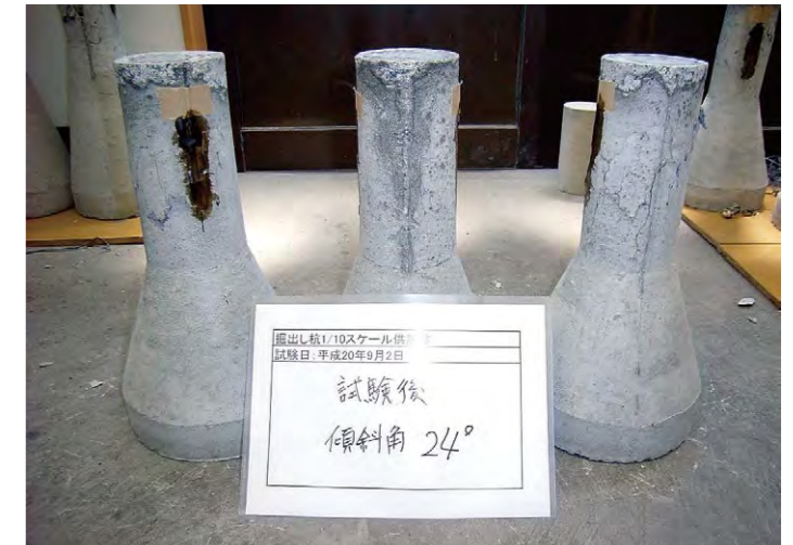
1/10モデル破壊実験供試体状況 (傾斜角24°)
