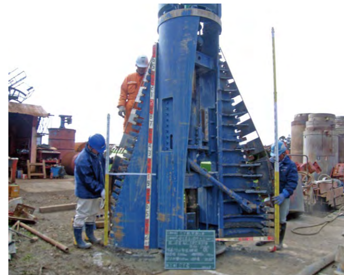
傾斜角20°用に改造したバケット (SY-1023バケット)
