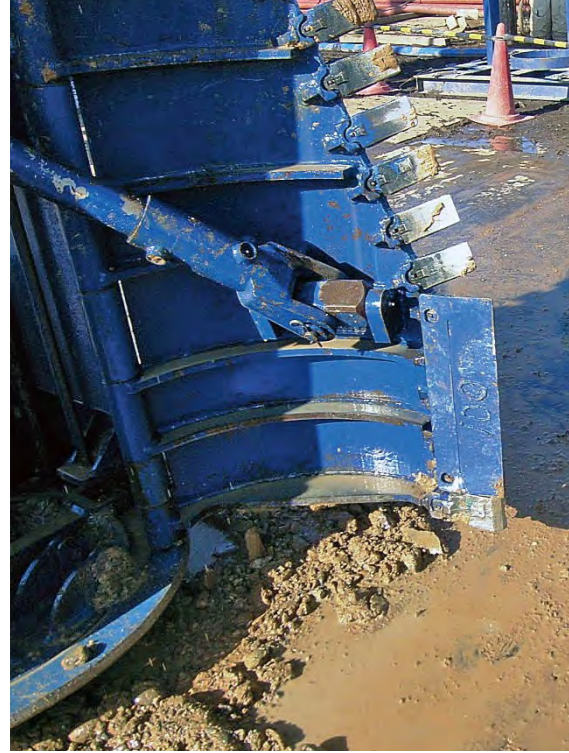
底ざらい用スクレーパー取付状況
